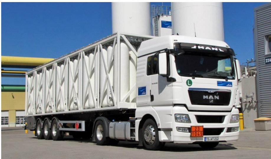
500 bar hidrojen treyler ile hidrojen taşımacılığı. Resim: Linde
